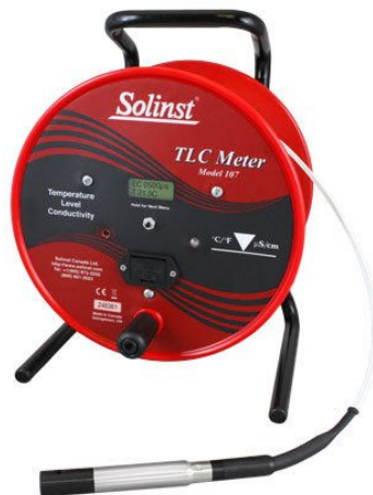
Mynd 7 Solinst Model 107 Hita-, leiðni- og dýptarmælir sem notaður var við mælingar á grunnvatnshita og leiðni. Heimild: https://www.solinst.com/products/level-measurement-devices/107-tlc-meter/
